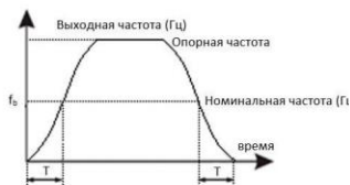
Рис. 6-3 Кривая S разгона/торможения B
