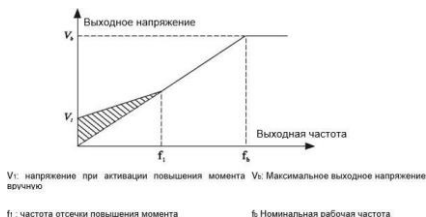
Рис. 6.6 — Повышение крутящего момента
