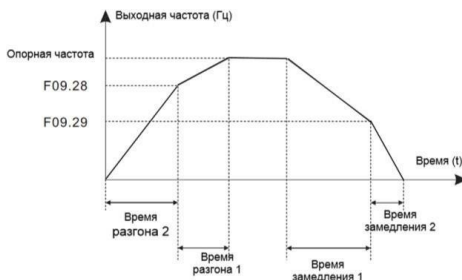
Рис. 6.19 — Частота переключения между временем замедления
