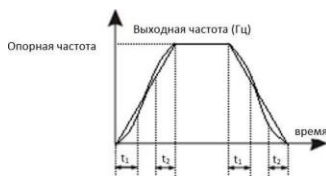
Рис. 6-2 Кривая S разгона/торможения A
