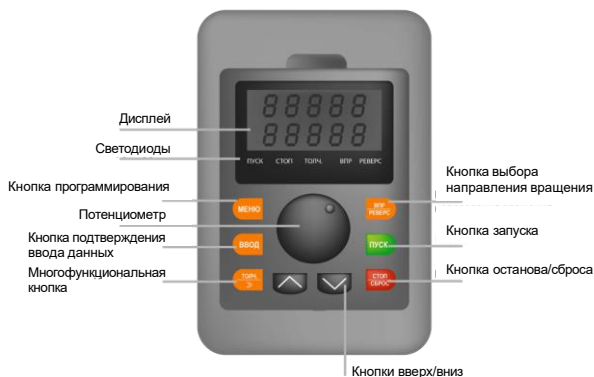
Рис. 5.1 – Функции кнопок и светодиодов панели управления LCI
